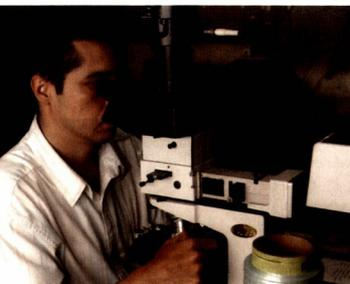
Determinación de la morfología de la fibra biconstituida utilizando microscopía óptica
