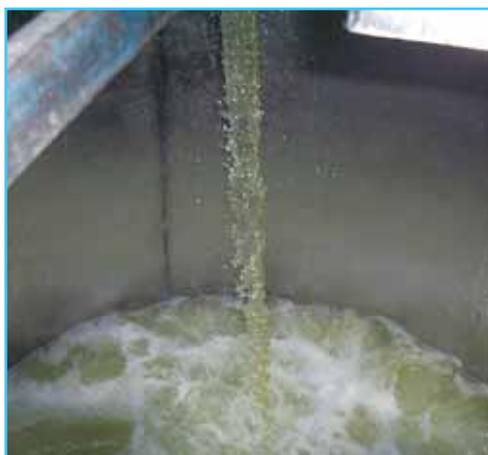
**Foto 5** **Mezclado de jarabes.** Agitadores desarrollados por la empresa para mantener el azúcar en suspensión.
