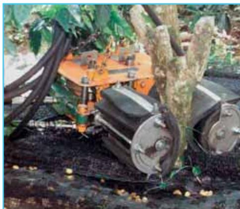
Fotos 3-4 A la izquierda, **Cosecha manual de café.** Herramienta ORESEL. A la derecha, herramienta con motor operado por batería, para asistir la recolección manual de café DESCAFE.
