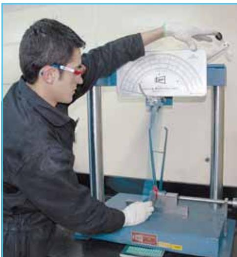
**Fotos 3-4** *Controles. A la izquierda, preparación de muestras para la evaluación de propiedades de impacto. A la derecha, desarrollo de pruebas de resistencia al impacto IZOD en muestras de los productos terminados.*
