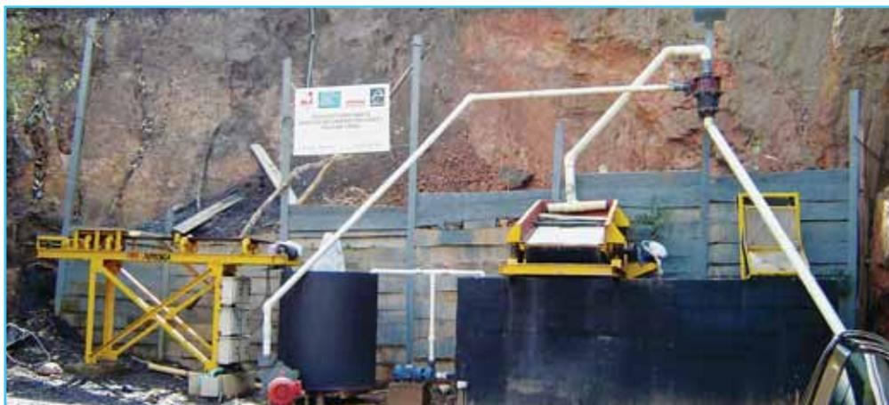
Foto 3 Planta de beneficio de carbones usando ‘separación ciclónica’.
