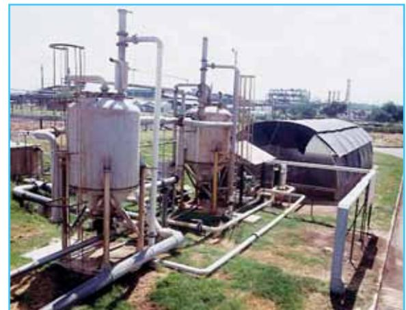
Fotos 1-2 Componentes del sistema. Biofiltro industrial en la compañía Sucromiles. A la derecha, detalle de los despojadores de H<sub>2</sub>S.
