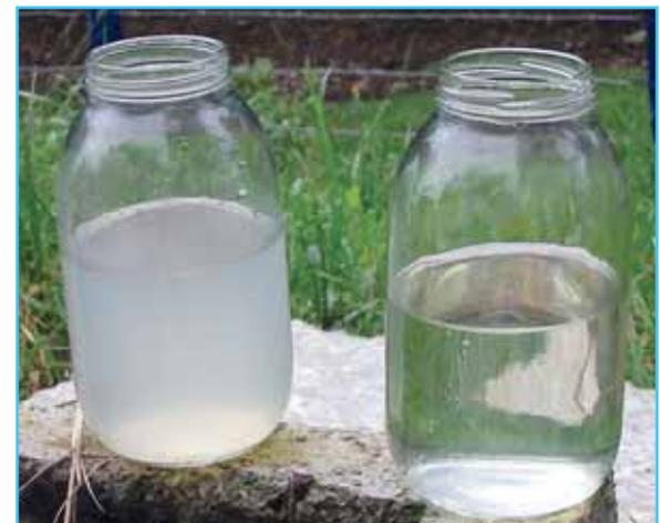
Foto 2 Comparación cualitativa del afluente y efluente del sistema de tratamiento.
