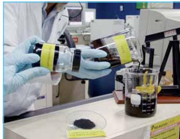
Foto 2 Carbón en forma de CCTA. La fluidez del CCTA es mayor que la del crudo pesado y similar a la del agua.
