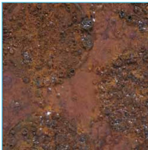
**Fotos 3-4** **Deterioro.** Aspectos de los cupones revestidos expuestos a las condiciones de ambientes simulados, en cámara salina -izquierda- y en cámara ácida -derecha-.
