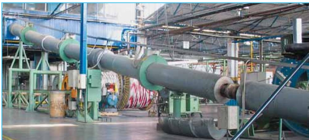
Foto 3 Línea catenaria con atmósfera de nitrógeno donde ocurre el curado.
