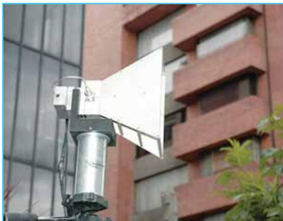
Foto 1 Antena. Medición de banda ancha con servomotor controlado por TESMonitor.
