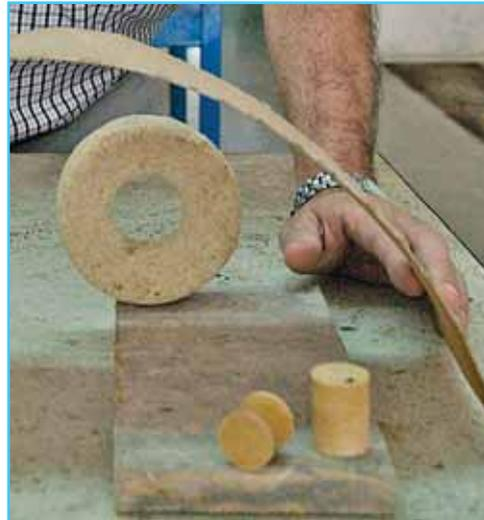
**Fotos 2-3** **Plastifique.** A la izquierda, lámina obtenida por calandrado. A la derecha, elementos diversos obtenidos por técnicas de moldeo a nivel piloto: calandrado, termocompresión, rotomoldeo y extrusión.
