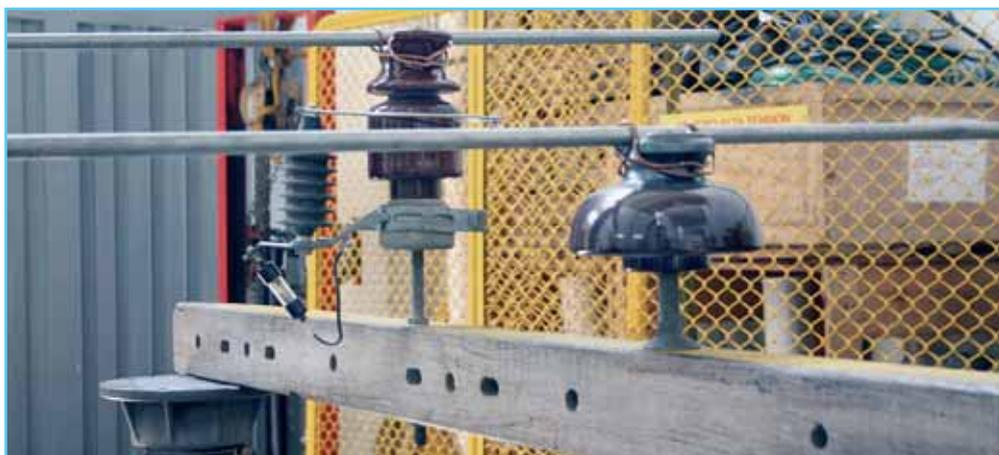
Foto 3 Evaluación. En los laboratorios de la U. Nacional de Colombia se comprobó el funcionamiento de aparatos de protección como los CLAHs (current limiting arcing horns).
