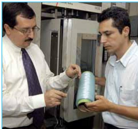
Foto 8 Estiramiento de las fibras biconstituidas en máquina universal de ensayos y horno de temperatura controlada.
