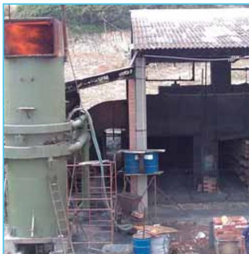
**Fotos 2-3** A la izquierda, **mezclador de gases**. Planta piloto construida por el grupo de investigación. Ladrillera San Cristóbal. A la derecha, **gasificador-combustor**. Vista general.
