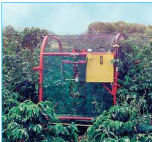
Foto 5 **Cosecha mecanizada del café.** Equipo para plantaciones de alta densidad.
