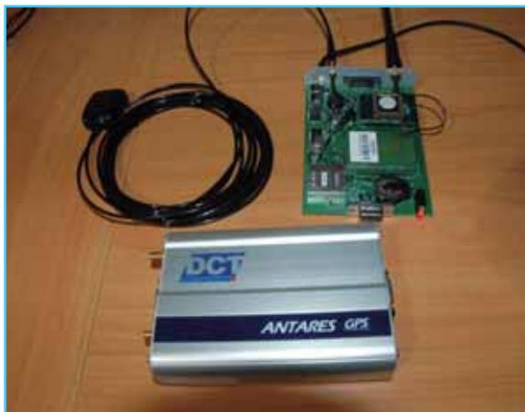
Foto 1 **Equipo.** Circuito impreso (arriba), producto terminado (abajo).
