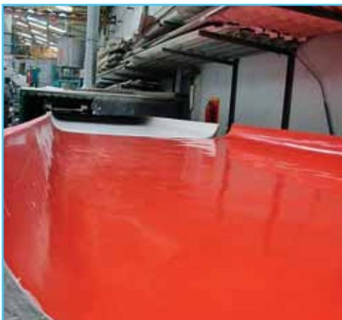
Foto 3 Molde listo para ser producida una pieza.
