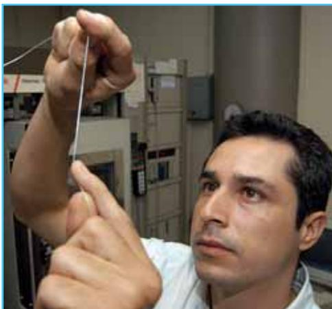
Foto 7 Fibra biconstituida de PP y PA6 producida industrialmente a velocidades de hasta 2.211 m/min.
