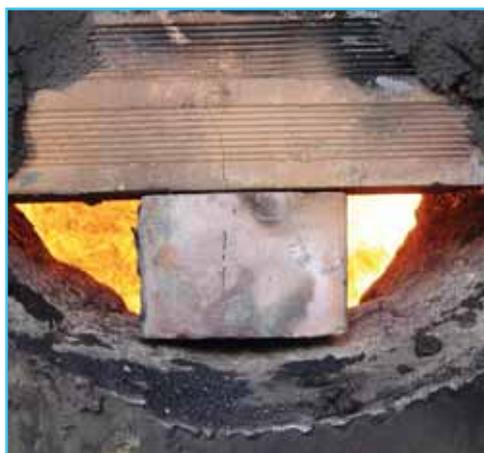
**Fotos 4-5** **Sistemas tradicionales.** Se observa la precariedad de los dispositivos. A la izquierda, medios de alimentación manual del carbón. A la derecha, soporte "hechizo" del acceso de ventilación.
