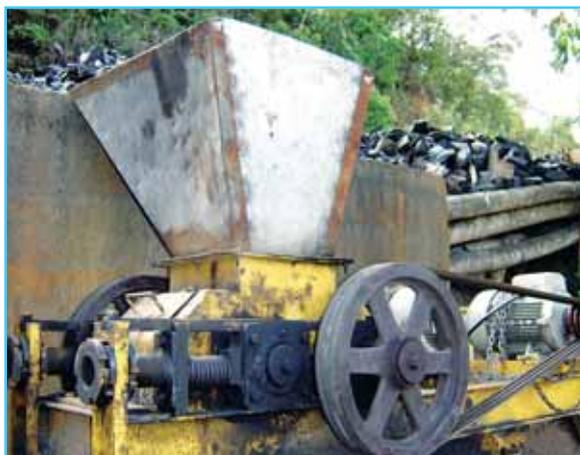
Foto 1 Trituradora de rodillos dentados de carbón.
