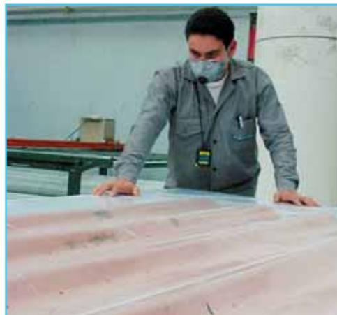
Foto 4 Inspección del molde cuando se está produciendo el vacío.
