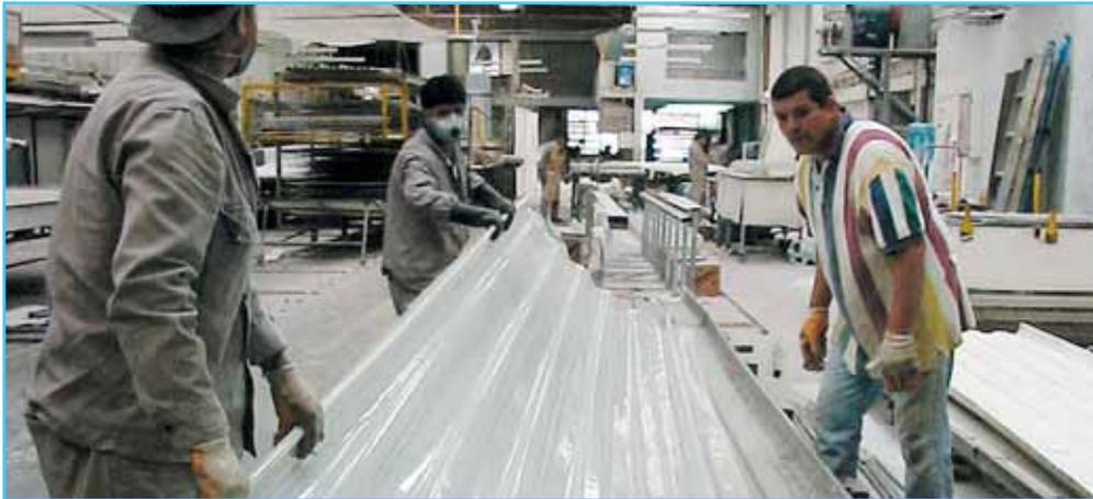
Foto 2 Desmolde de la lámina ondulada traslúcida.
