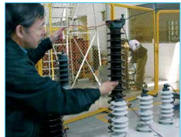
**Foto 2** Evaluación. Comprobación de la posibilidad de reducir los aislamientos de las estructuras y concentrarse en las protecciones contra sobretensiones.
