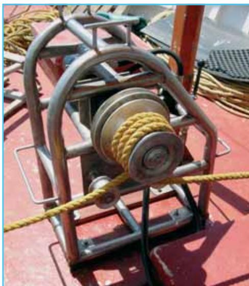
**Foto 3** Máquina cobralíneas hidráulica para el virado de cabos y artes de pesca.
