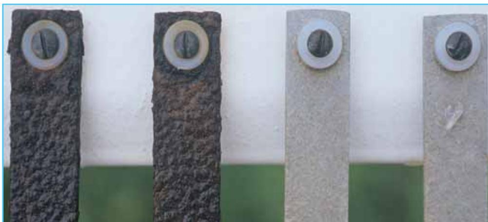
**Foto 5** **Corrosión.** Cupones atmosféricos de acero al carbono y aluminio expuestos en racks a campo abierto. Zona Industrial de Mamonal.
