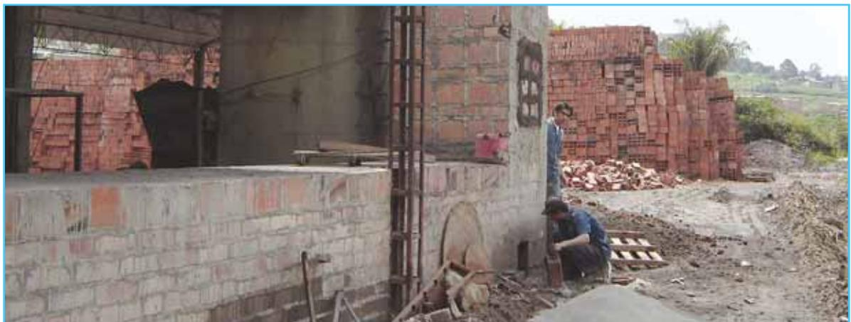
Foto 1 Conducto de gases. Una tecnología limpia para suministrar gas caliente para el secamiento de ladrillo.
