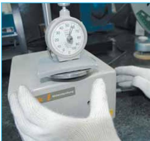
**Fotos 5-6** *Controles. A la izquierda, evaluación colorimétrica de probetas sometidas a envejecimiento por el método CIELAB. A la derecha, mediciones de dureza de partes de la silla.*
