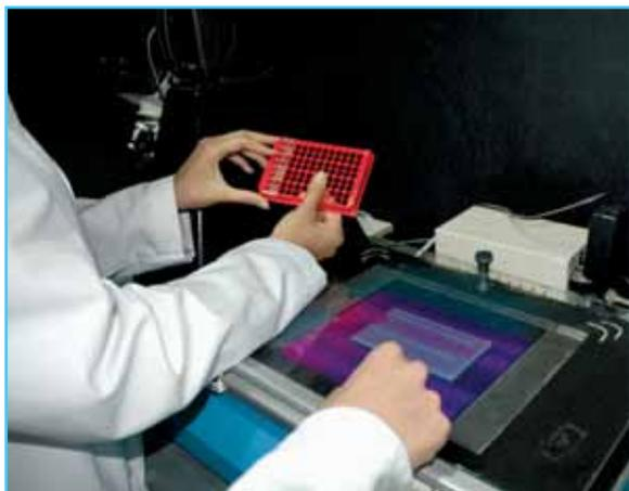
**Foto 1** El kit TB-Millennium se desarrolló uniendo dos técnicas utilizadas en los laboratorios de diagnóstico: la Reacción en Cadena de la Polimerasa y ELISA, una prueba inmunológica de amplio uso.
