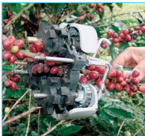
Foto 6 **Herramienta.** Dispositivo para asistir la recolección manual de café - DESCAFE.
