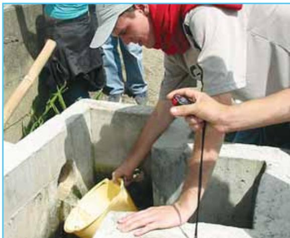
Foto 1 Monitoreo efluente final planta de tratamiento.
