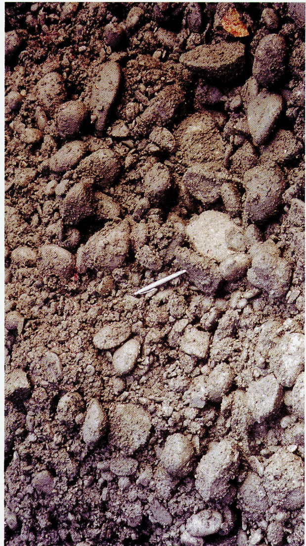
▲ FIGURA 1. CONCRETO COMPACTADO CON RODILLO (C.C.R.)
