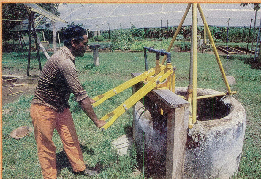
Bomba de camisa Gaviotas para extracción de agua.
